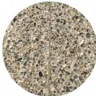
Formigó desactivat amb àrid vist
